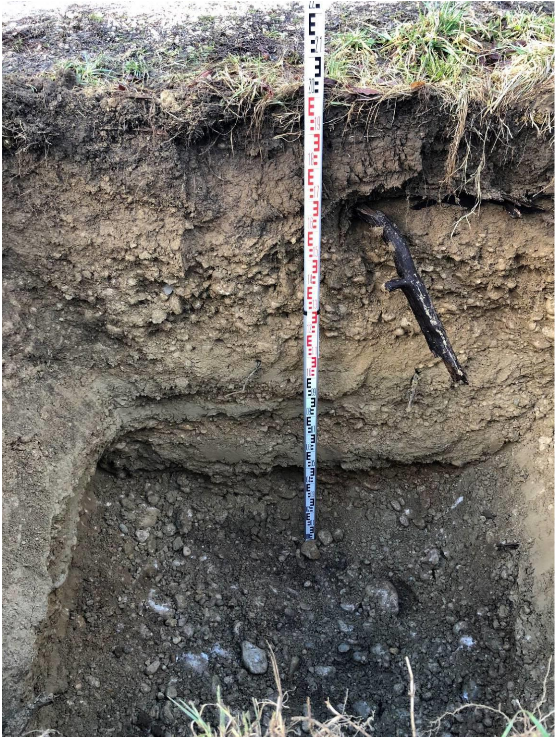
Fouille CL-01 à 2.0 m de profondeur par rapport au terrain naturel.
